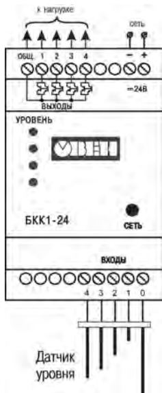
Рисунок 5.3 – Схема подключения БКК1-24
